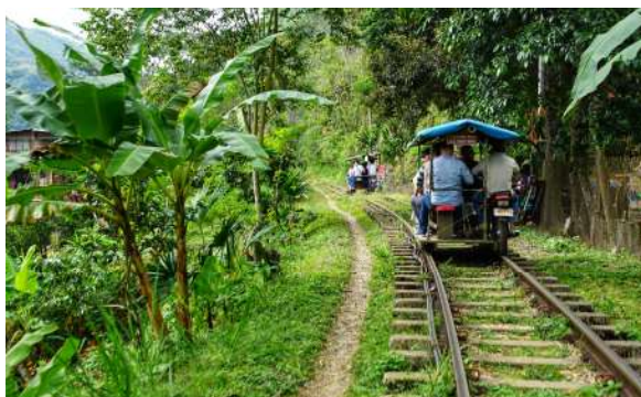
Einbahnstraßen-Schienensystem mit Motorradantrieb: ideal für eine Gegend, in die keine Straße mehr führt. (Fotos: Club der Confiseries)
